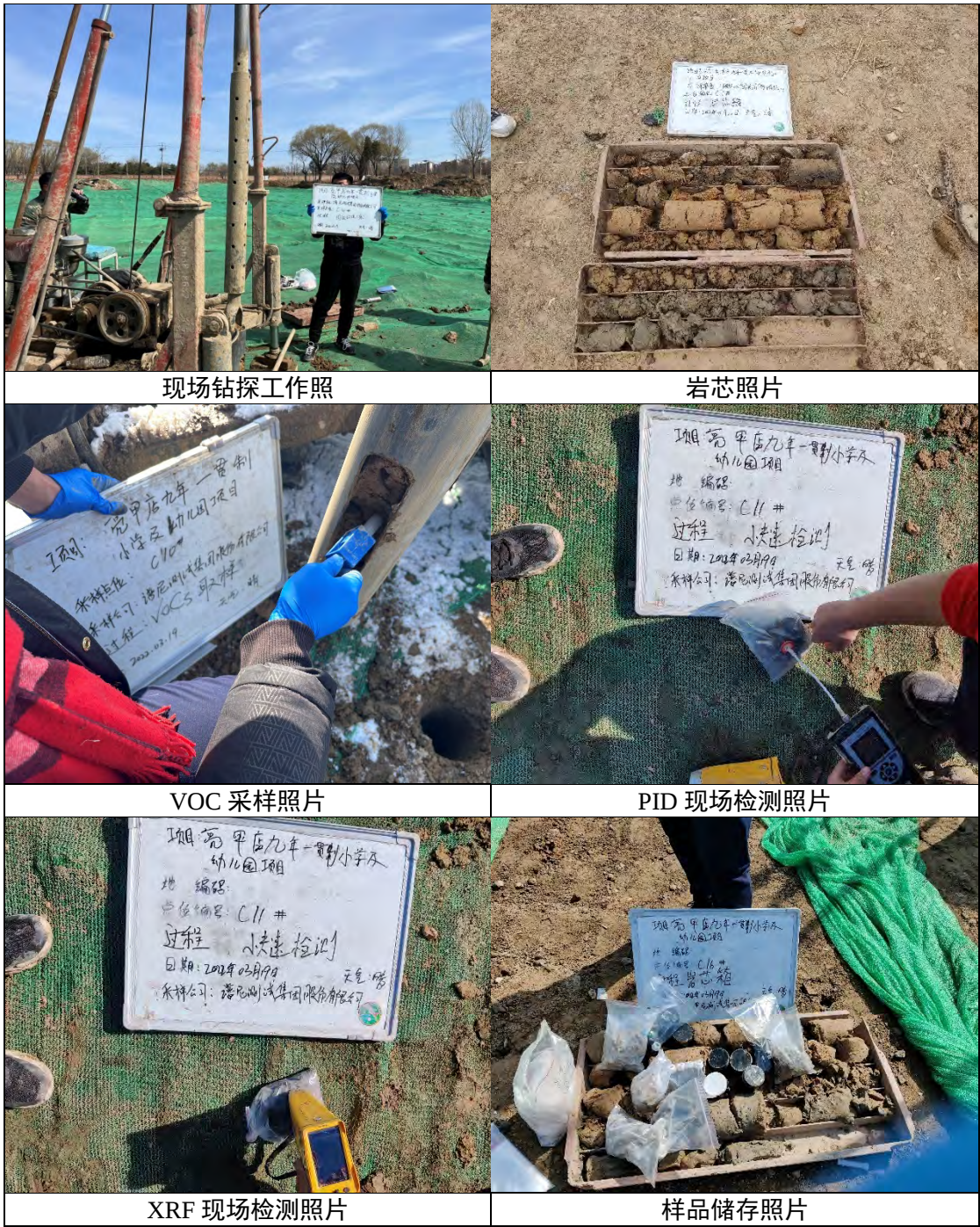
图 4-5 土壤采样现场照片
