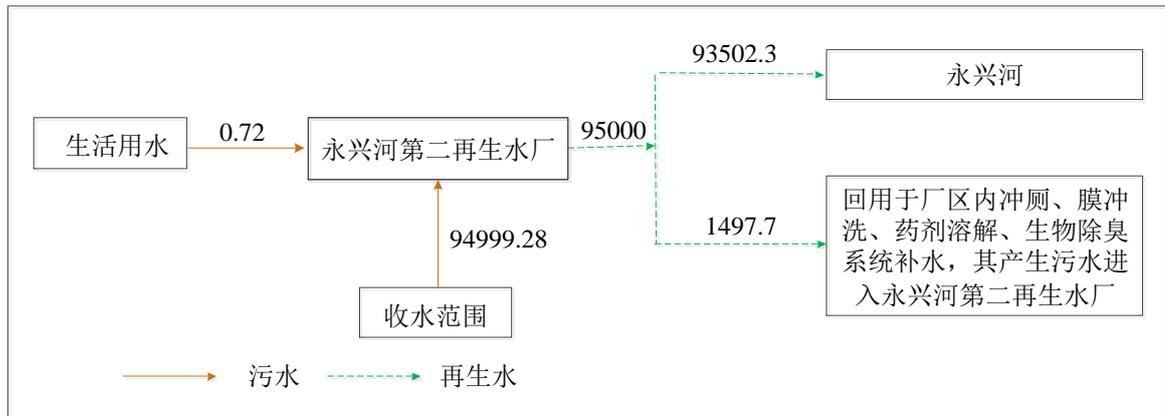
图5 本项目冬季水平衡图 (m³/d)
