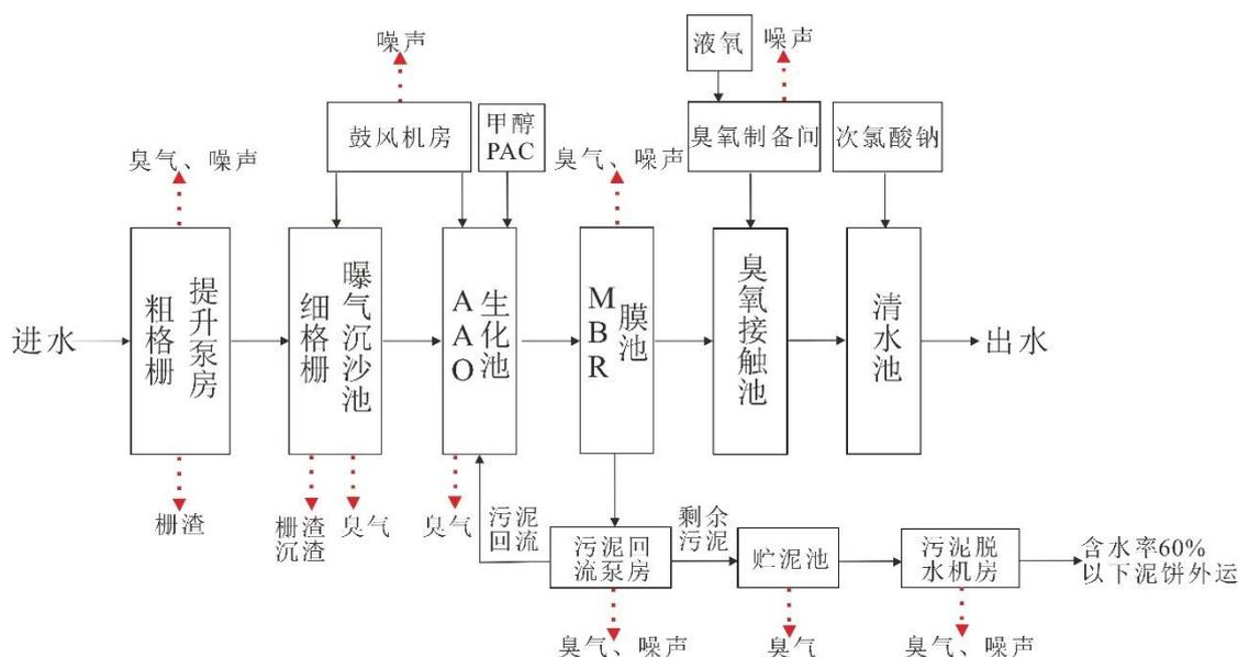
图3 本项目运营期污水处理工艺流程图
