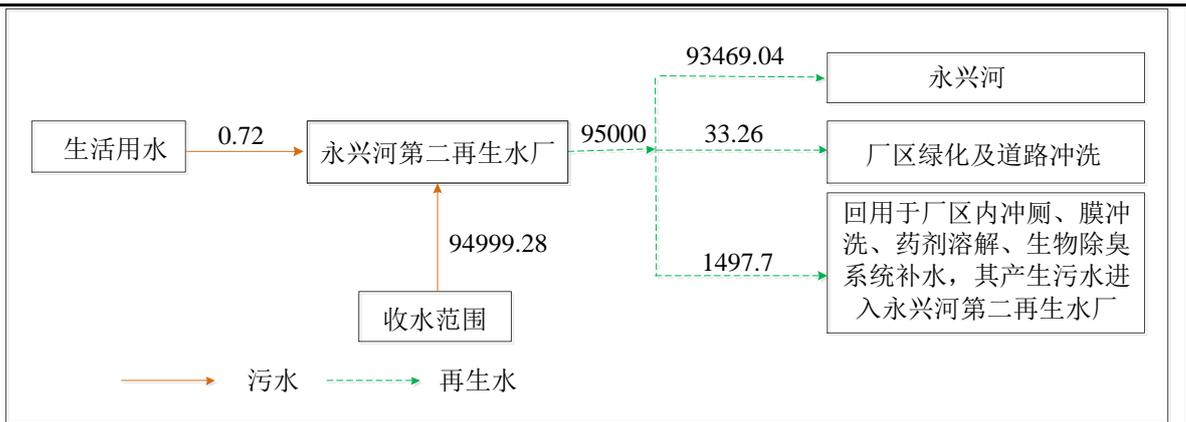
图4 本项目春、夏、秋季水平衡图 (m³/d)
