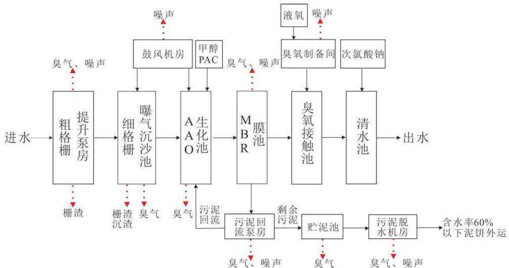
图 7 本项目运营期污水处理工艺流程图
