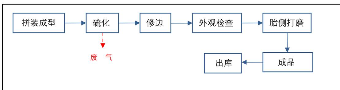
图 3.3-1 北京燕轮橡胶制品公司生产流程图
