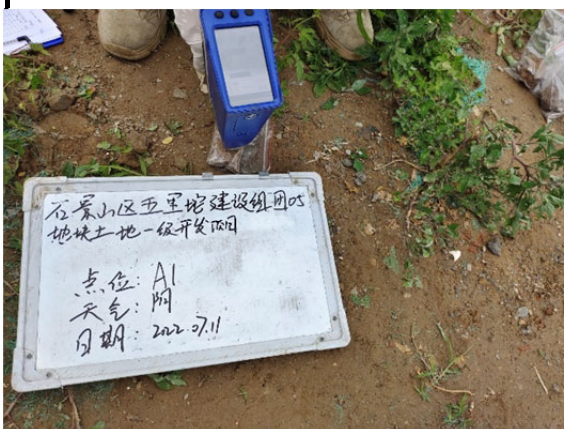
PID 现场检测仪检测
