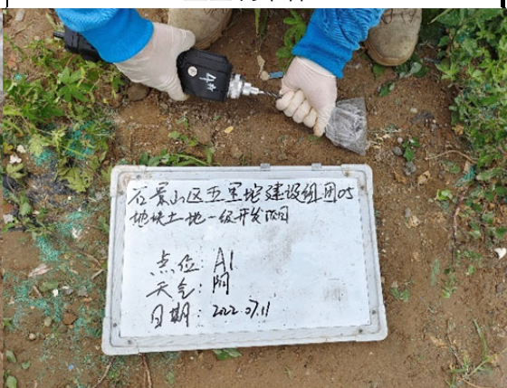
XRF 现场检测仪检测
