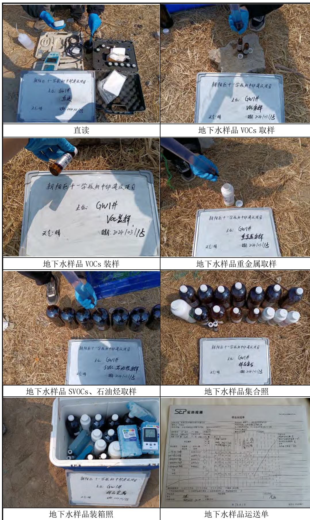
图 4.4-8 地下水样品的采集
