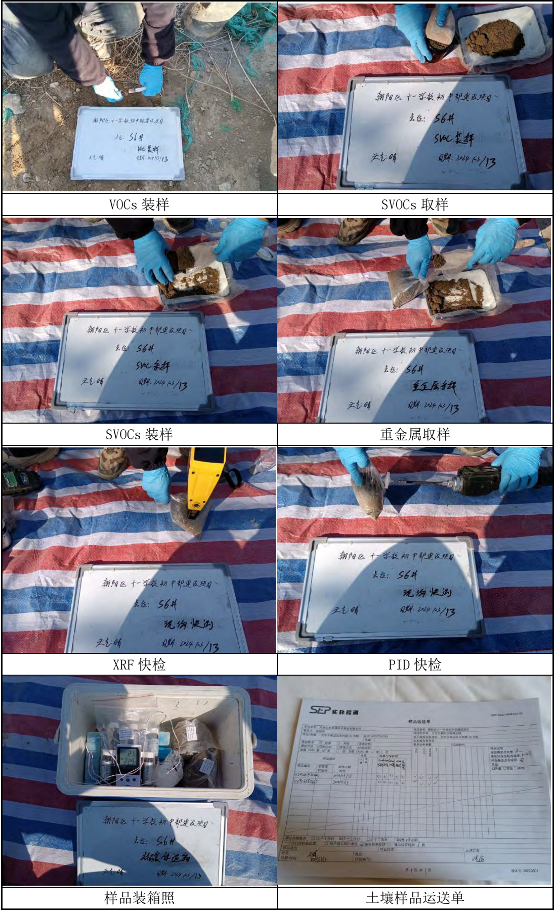
图 4.4-2 土壤采样现场照片
