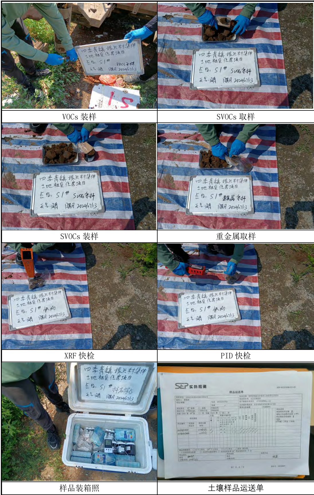
图 4.4-2 土壤采样现场照片
