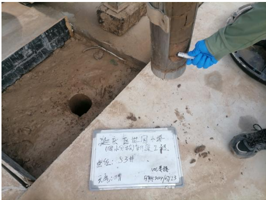
VOCs 取样-钻头采取样品
