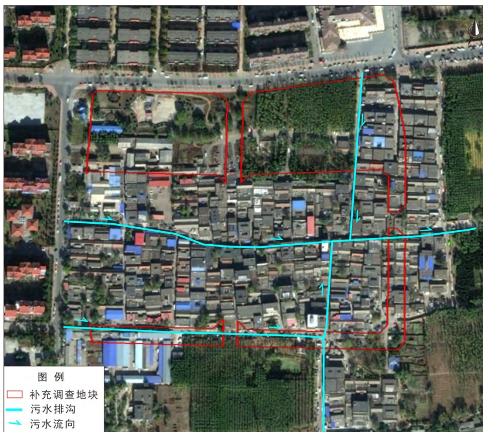
图 3.4-1 拆迁前宝山村排污沟位置示意图
