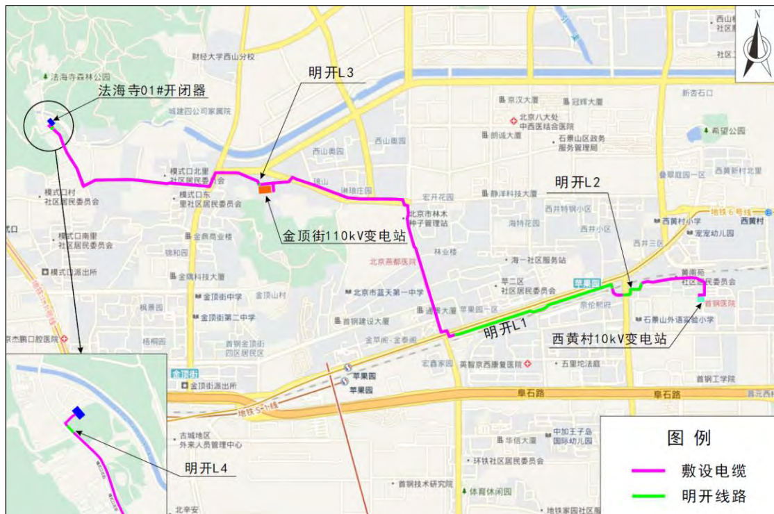
图 2 实际施工路由
