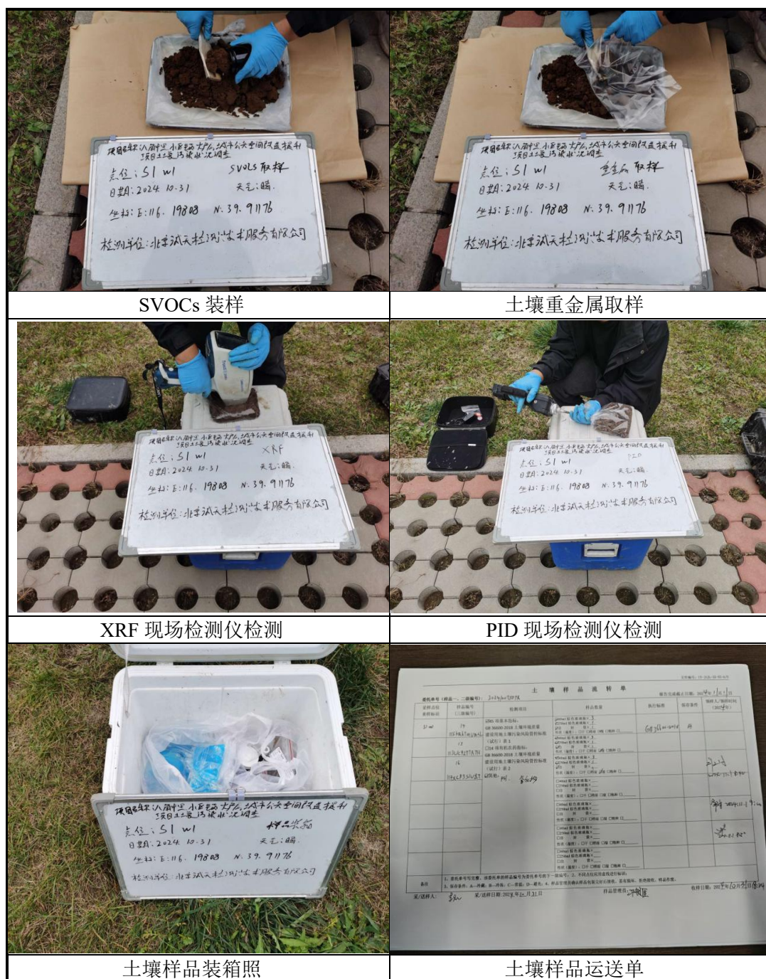
图 4.4 土壤采样现场照片
